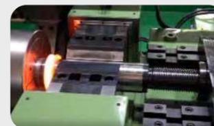
4. SPINDLE紧急停止, UP SET加压
