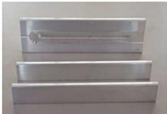
06. 线性摩擦焊接LFW适用案例
