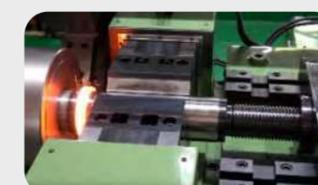
3. 开始接触素材, 摩擦生热
